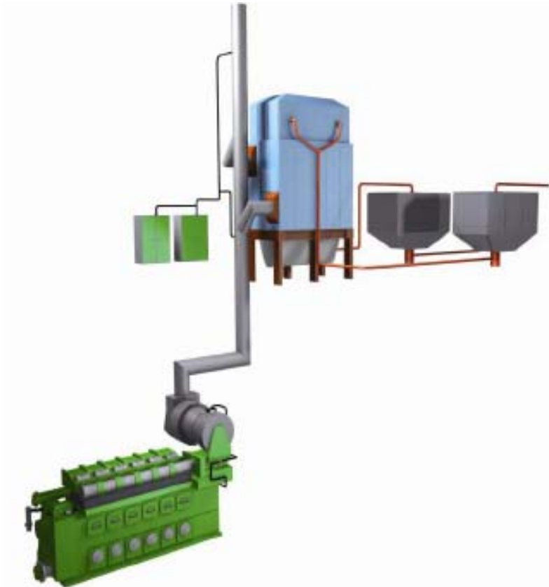
Figura 25: Representació d'un rentador de tipus sec a bord.
