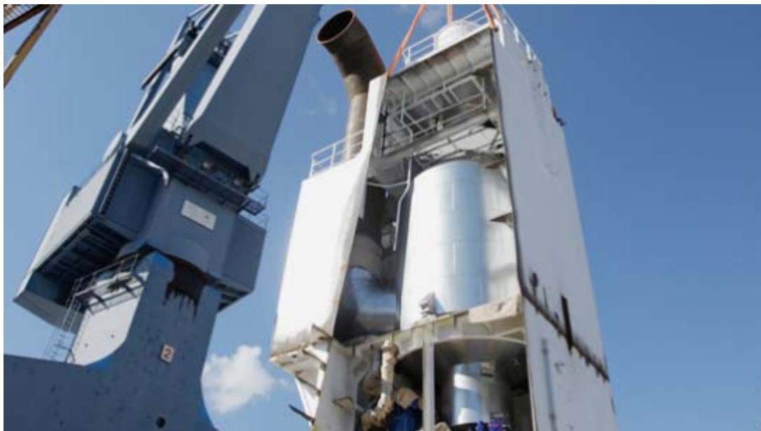
Figura 26: Imatge real d'un rentador instal·lat a un buc
