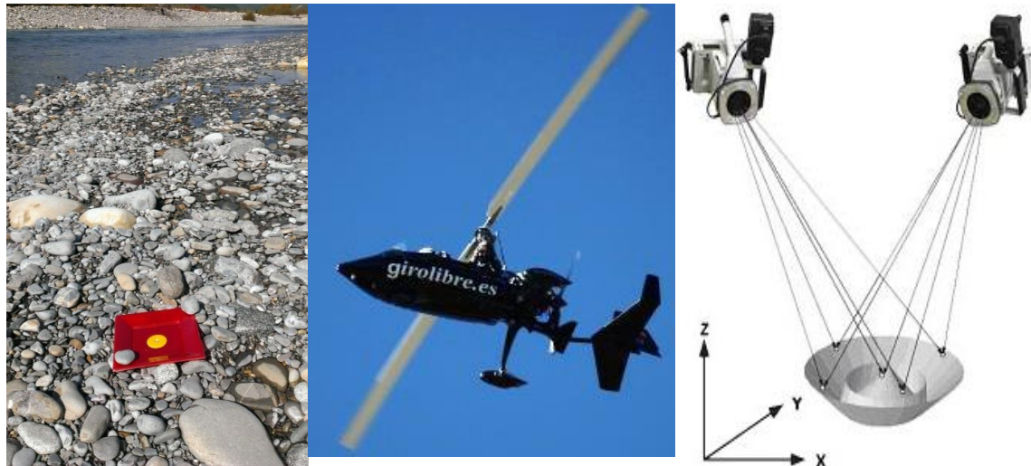
Figura 5: Punt de control i dron utilitzat per la fotogrametria digital. Esquema de funcionament de SfM.
