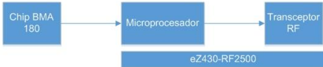
Fig. 3.6 Diagrama de bloques del Nodo ED-BMA180
