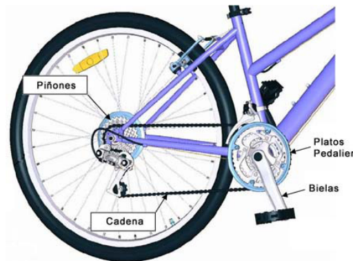
Fig. 1.8 Transmisión bicicleta: plato y piñones [8]
