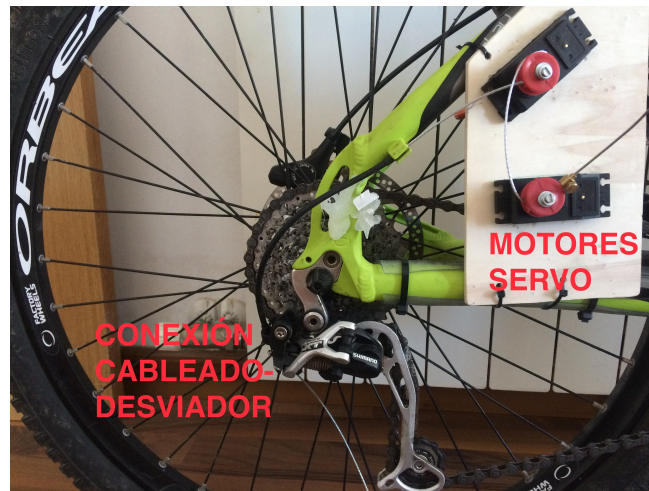
Fig. 3.25 Instalación de los motores servo
