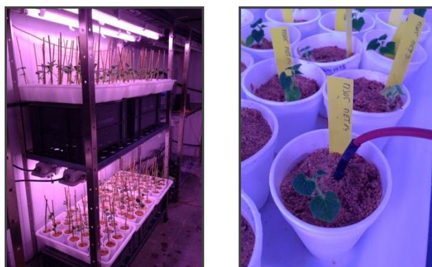
Figura 5 Izquierda, una parte de la cámara en donde se muestra las estanterías y el tipo de iluminación; derecha sonda (Campbell Scientific Ltd. ©) que registra la T º del sustrato. Fuente: propia
