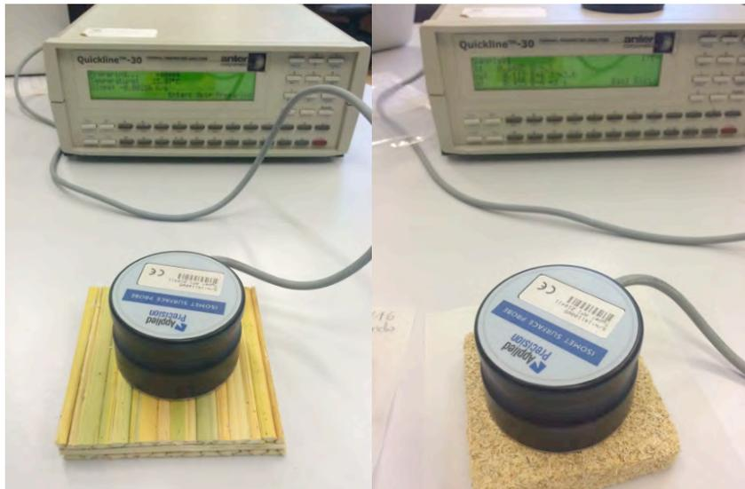
Imagen 76: Pruebas de conductividad térmica.
