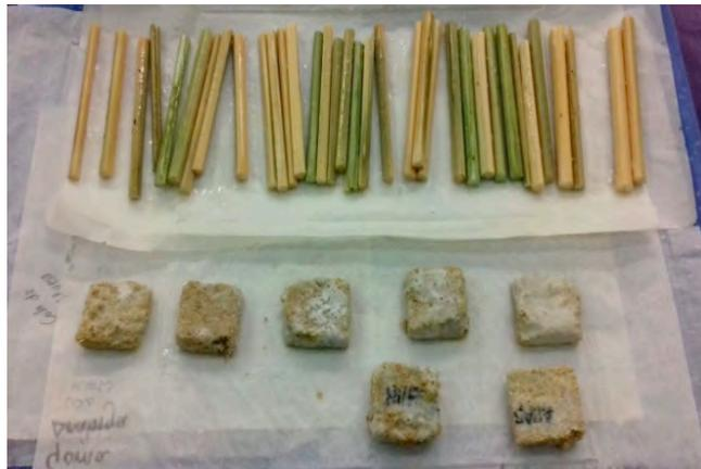
Imagen 96 :Probetas tratadas con una mezcla líquida de alumbre y borax.
