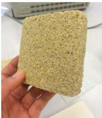
Imagen 67: Probeta elaborada con la fibra más menuda - fondo.
