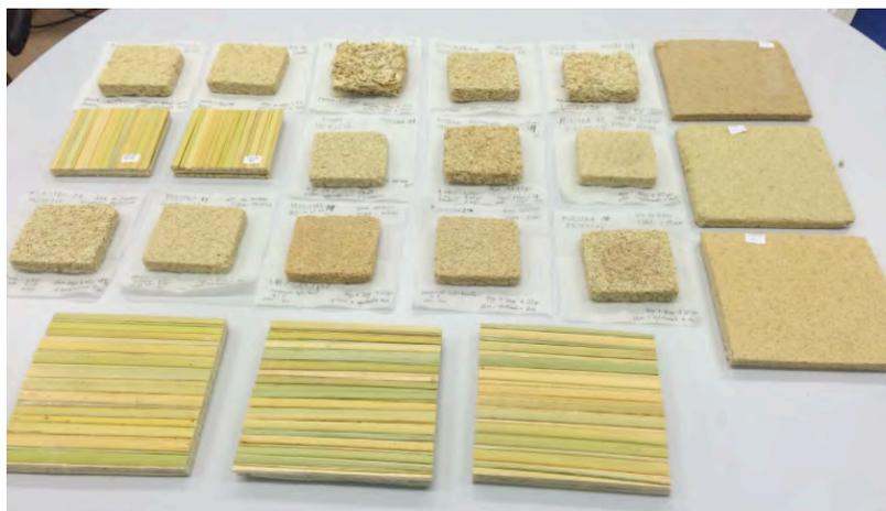
Imagen 75: Probetas elaboradas con distintos aglutinantes y diversos tamaños de fibra.
