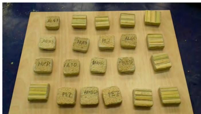
Imagen 97 :Probetas con bordes recubiertos con cemento refractario.
