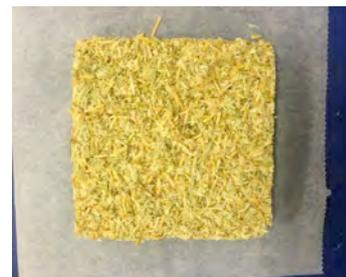
Imagen 63: Probeta desmoldada.
