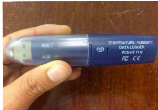
Imagen 82: Dataloger para la medición de la temperatura .
