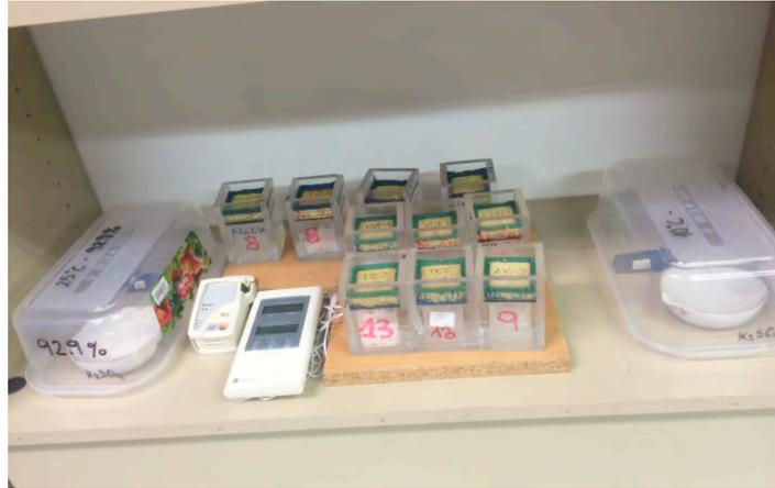
Imagen 77: Probetas preparadas para el cálculo de permeabilidad de agua .
