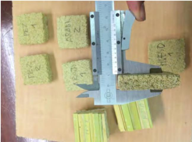
Imagen 79: Probetas cortadas a 4 x 4 cm .
