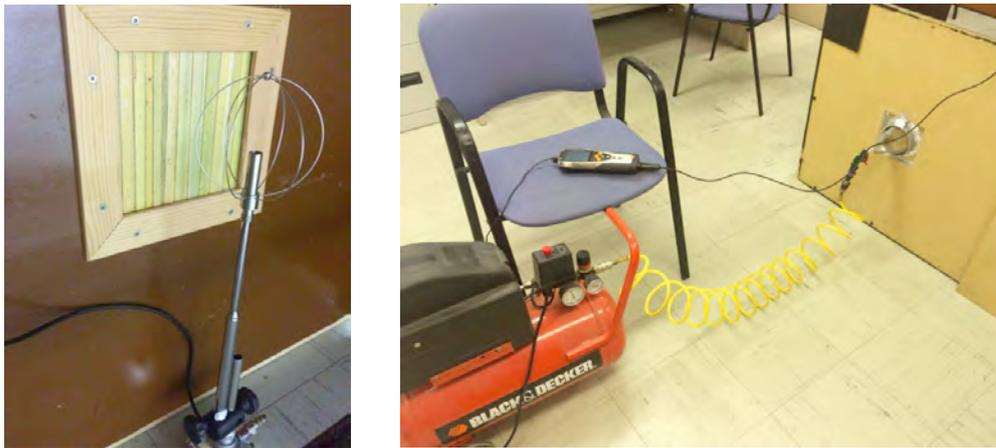
Imagen 84: Anemómetro de bola caliente y sistema montado para realizar la prueba.
