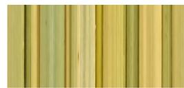
El presente ensayo se ha realizado según la norma UNE EN ISO 12572, tiene por finalidad obtener el factor de resistencia al vapor de agua de las probetas de totora.
