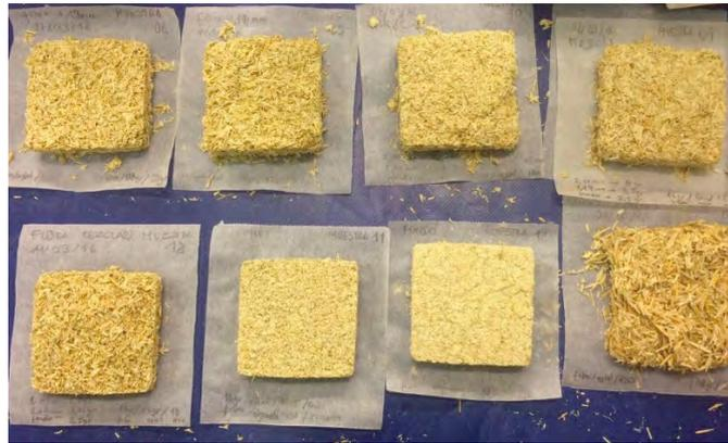
Imagen 66: Probetas desmoldadas., pruebas con distintos tamaños de fibra.
