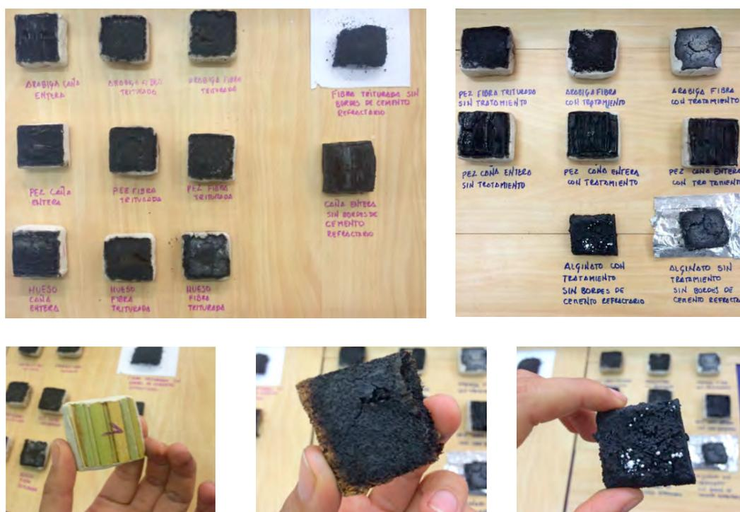
Imagen 99: Probetas después de ser sometidas al ensayo de radiador, las que han sido tratadas con bórax presentan mayor
