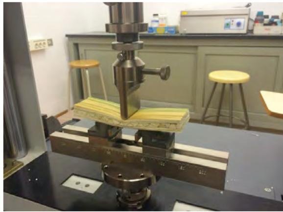
Imagen 91: Probetas de caña entera siendo sometidas a cargas.
