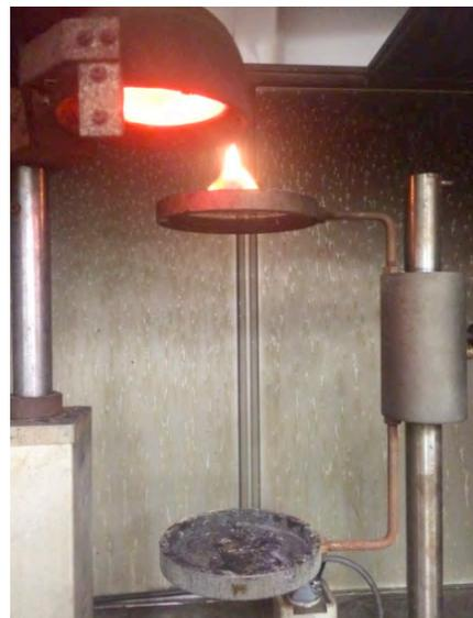
Imagen 95 :Probeta siendo sometida al ensayo de radiador .
