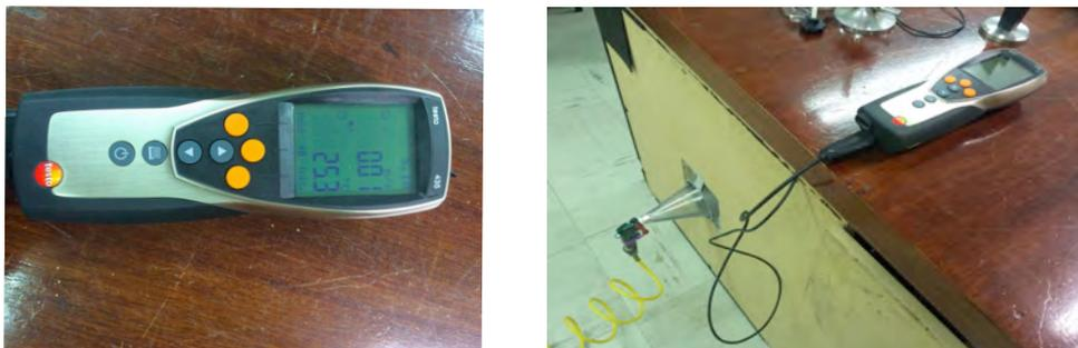
Imagen 85: Dataloger: registra la velocidad del aire .
