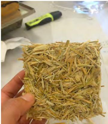
Imagen 65: Probeta elaborada con el tamaño más grueso de fibra - 3.2mm .
