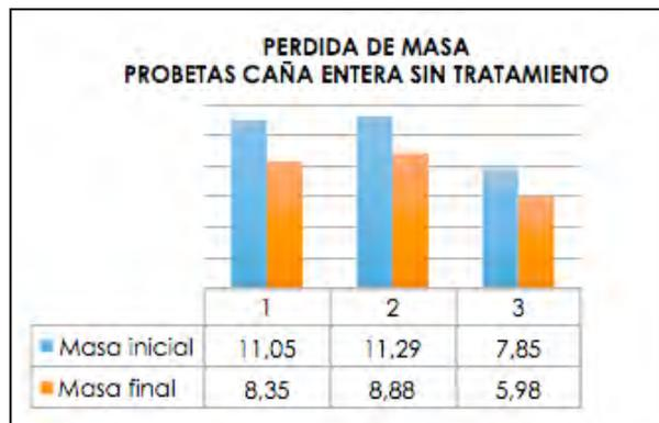
Imagen 100: Gráficos comparativos de la pérdida de masa entre probetas
