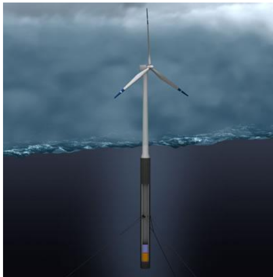
Figura 1.21. Estructura spar buoy (Hywind) [13].
