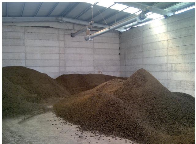
Figura 5.7.3. Producto final del digerido secado. Granja Green Energy - Brescia, Italia (CRPA, 2015)
