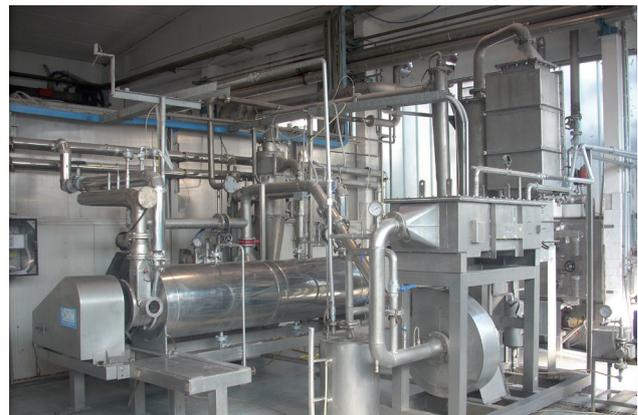
Figura 5.7.5. TurboDryer con un rotor interno de alta velocidad. VOMM - Milán, Italia (CRPA, 2013).
