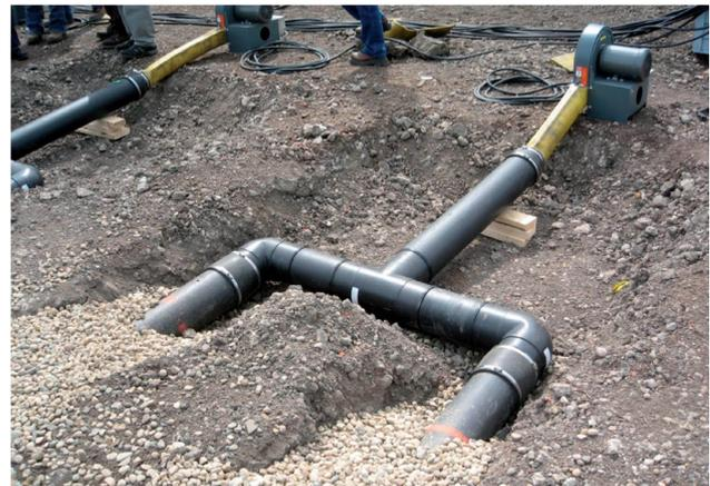
Figura 5.5.5. Compostaje en hilera (windrow composting): sistema de pila estática con aireación forzada. Vista del sistema de aire forzado.
