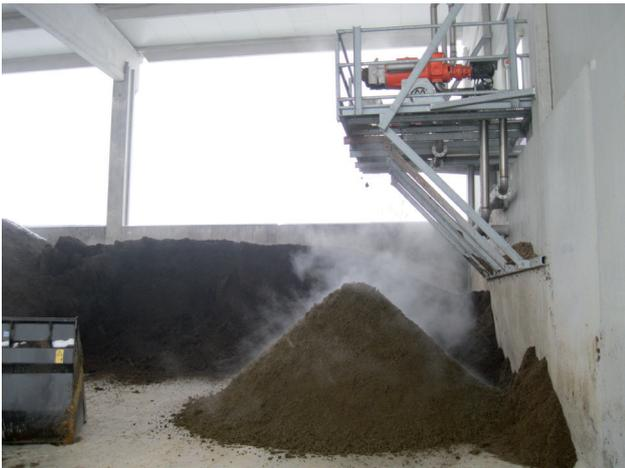
Figura 2.3.2. Separador de fase (tornillo prensa). Vista de la fracción sólida.
