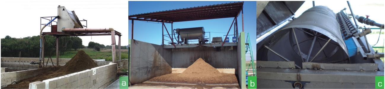
Figura 5.2.4. a) Tamiz estático instalado en una explotación lechera; b) y c) tamices rotativos.
