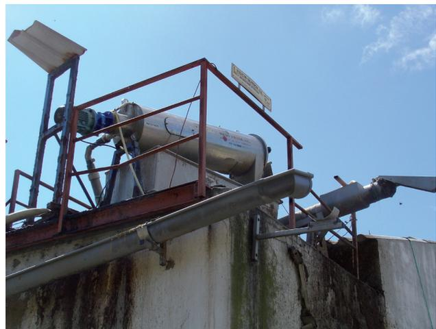
Figura 5.2.6. Tornillo prensa en una granja porcina.
