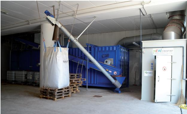
Figura 5.7.4. Planta de secado: cámara cerrada (azul) que contiene el sistema de cintas de soporte, la caja del lavador (blanco) y la bolsa con digerido seco enfrente de la «Flubox™» que contiene la solución de sulfato de amonio. Granja San Giuliano - Trento, Italia (CRPA, 2013).
