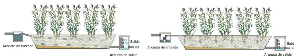
Figura 5.10.2. Esquema de un humedal de flujo subsuperficial con flujo horizontal (izquierda) y flujo vertical (derecha) (ARPAT, 2005).
