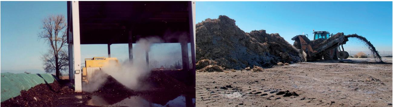
Figura 5.5.3 y 5.5.4. Compostaje en hilera (windrow composting): maquinaria de volteo.
