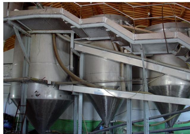
Figura 5.2.2. Decantador cilíndrico con base cónica.
