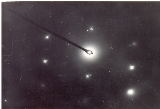
Рис. 5. Электронограмма от выделений \theta' фазы в состаренных образцах
