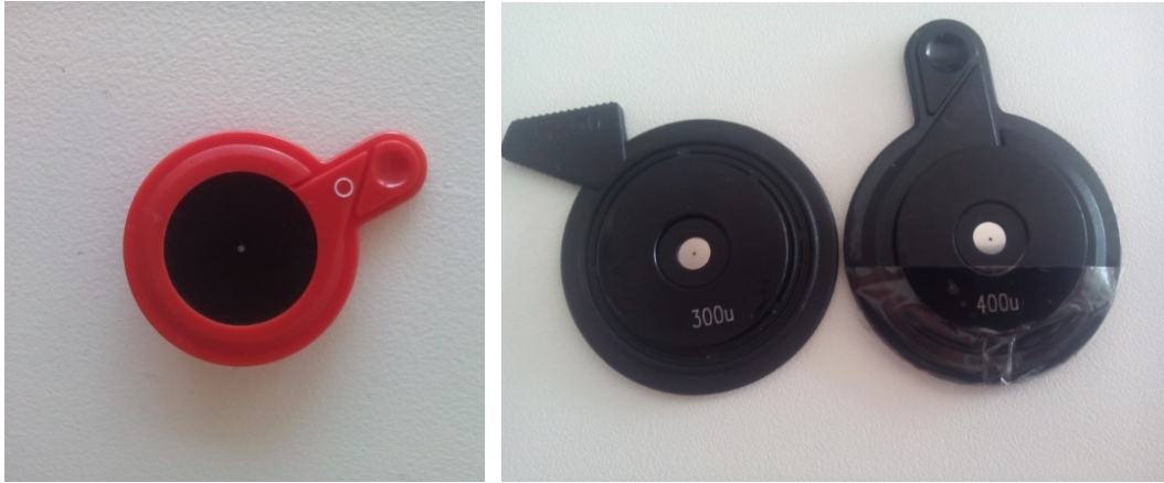
Figura 5.1. Pinholes adaptados a las monturas de las lentes de prueba.
