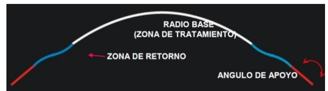
Figura 2.6. Perfil de una lente con geometría sigmoidal
