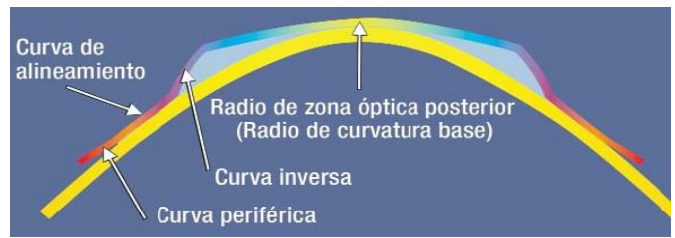
Figura 2.4. Perfil de una lente de doble geometría inversa
