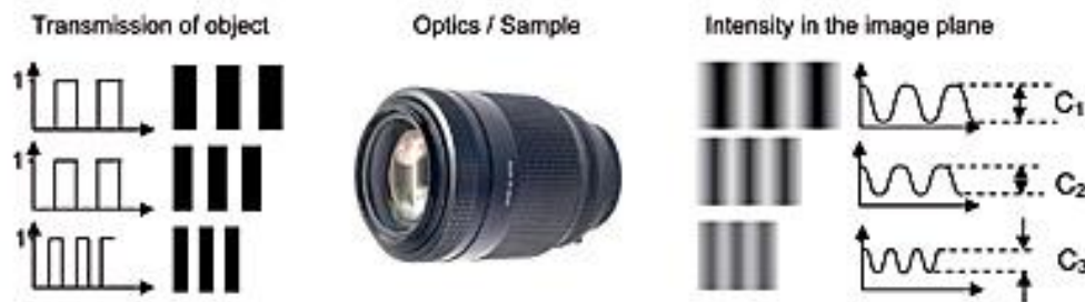
Figura 4. Concepto de MTF: Variación del contraste de la imagen en función de la frecuencia espacial del objeto.
