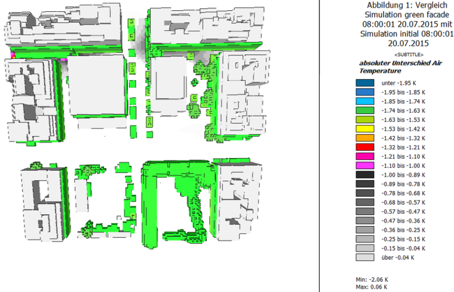
Εικόνα 3.51. μεταβολή της θερμοκρασίας του αέρα σε ύψος 1,80 m για την ώρα 8:00, στην προσομοίωση green facades σε σχέση με την υφιστάμενη κατάσταση. [πηγή: LEONARDO, προσωπική εργασία]
