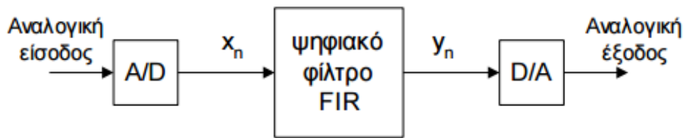
Σχήμα 2.11. Χρήση ψηφιακών φίλτρων σε αναλογικά σήματα
