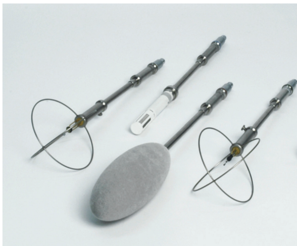
Εικόνα 3.2.2 Αισθητήρες θερμοκρασίας, σχετικής υγρασίας, ταχύτητας αέρα
