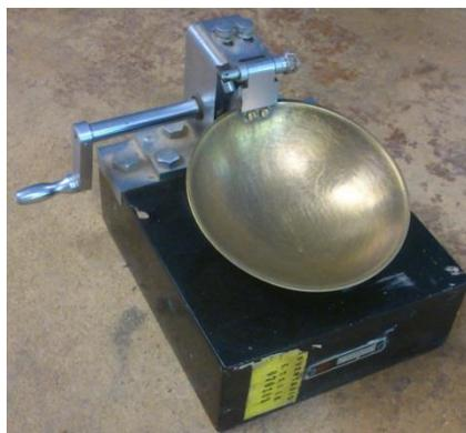
*Figura 10: Cuchara de Casagrande para la determinación del límite líquido.*
