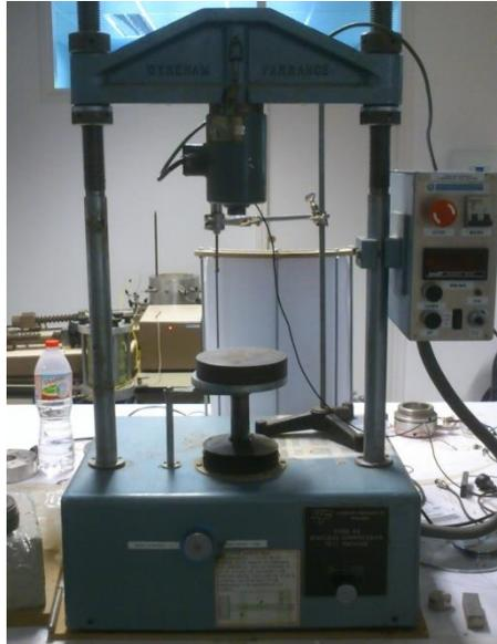
*Figura 25: Prensa para obtener la densidad seca inicial requerida.*
