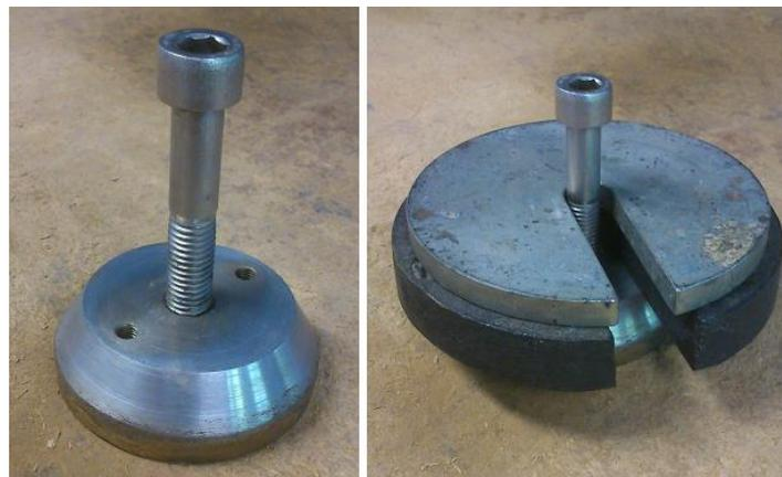
Figura 24 Detalle pistón modificado para la colocación pequeñas cargas.
