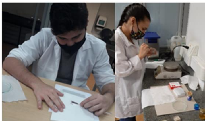
Figura 7. Proceso de cuarteo y montaje de granos densos
