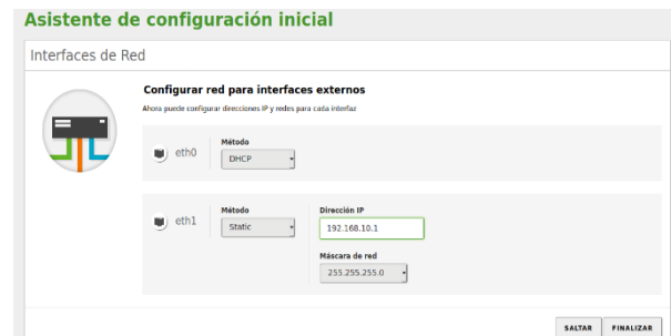
Figura 1. Debemos ingresar a la configuración en el icono que nos presenta configuración y nos aparecerá la siguiente imagen, donde vamos a realizar la configuración del rango de ip para el dhcp
