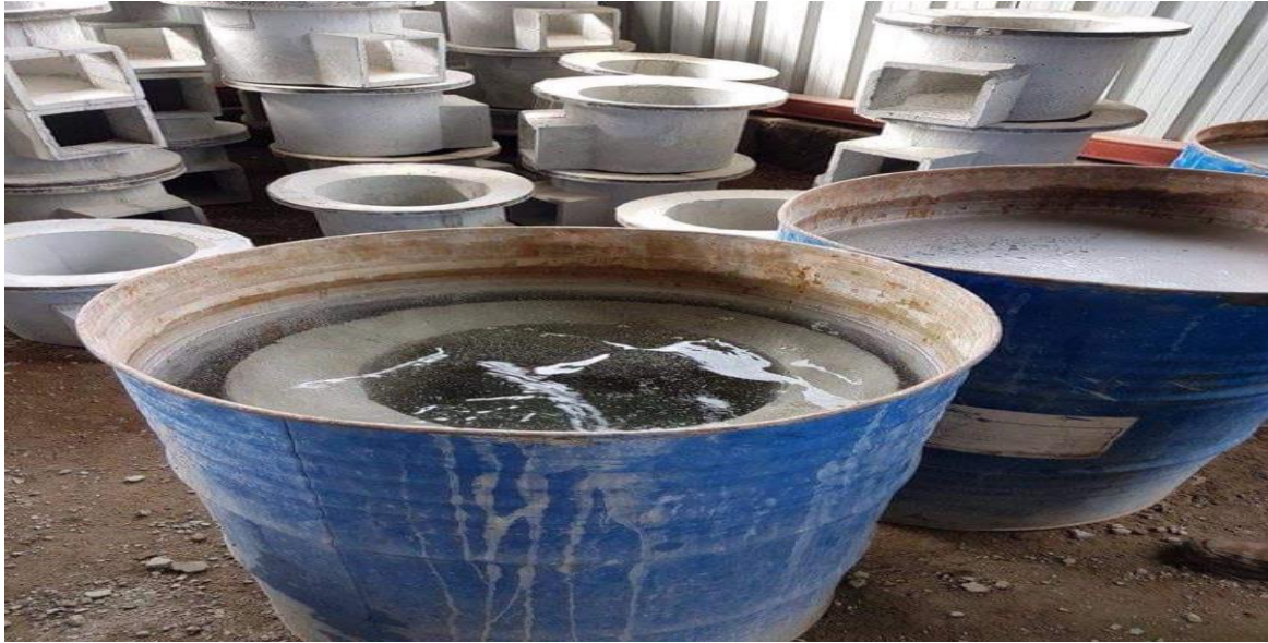
Fotografía 4. Área de molde (hidratación en barriles con agua)
