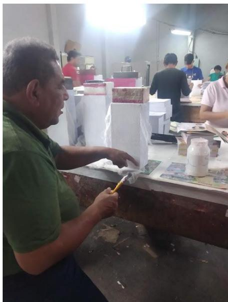
*Ilustración 38 Trabajador empleando pegamento con alto grado de toxicidad.*
