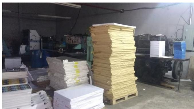
*Ilustración 35 Materia prima y productos semiacabados mal estibados.*
