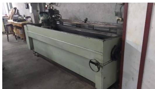
*Ilustración 9 Puesto de afiladora de cuchillas.*
