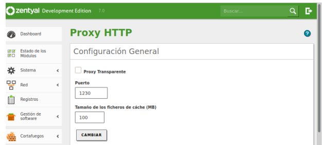
Figura 7. Activación Proxy Transparente
