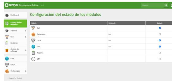
Figura 15. Instalando y habilitando módulo DNS.
