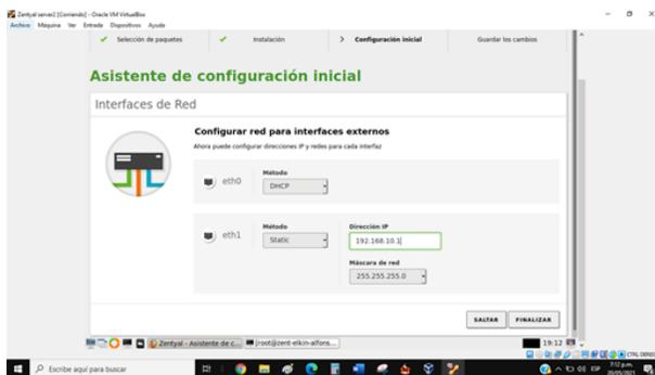
Figura 49. Configuración de interfaces de red
