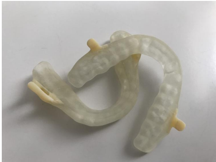
Figura 6.13. Férula inferior y superior del dispositivo propuesto terminado mediante fabricación mixta.
