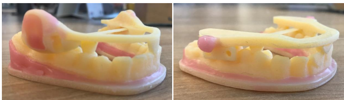
Figura 6.11. Planificación de los elementos de referencia y los pares de levas y seguidores necesarios para montar el dispositivo mediante fabricación mixta. A la izquierda, el montaje de la férula inferior y a la derecha la férula superior.
