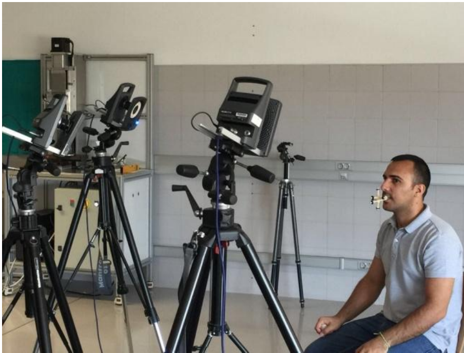
Figura 4.19. Grabación del movimiento mandibular con el sistema de cámaras infrarrojas.
