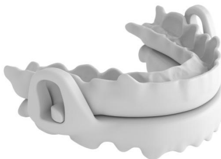
Figura 6.8. Ejemplo del dispositivo propuesto fabricado con la impresora Formiga P110 Velocis y material Poliamida 12.
