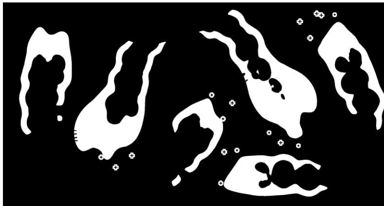
Figura 6.5. Ejemplo de una capa de impresión con tecnología DLP.
