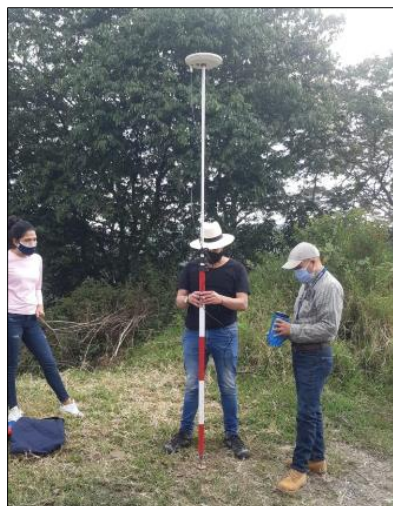
Fotografía 2. Levantamiento de puntos de control con el rover por GPS RTK
