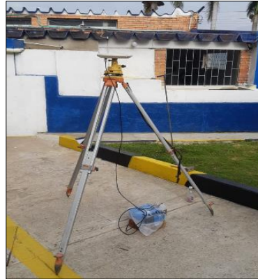
Fotografía 1. Punto GPS1, base georeferenciada en tiempo real
