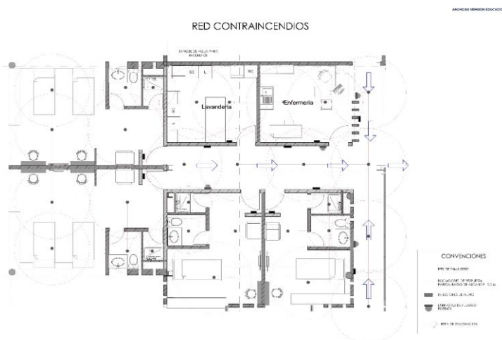
Ilustración 42 Planta de red contraincendios. Elaboración propia
