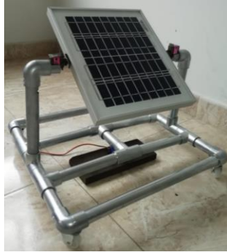
Figura 46 Estructura de seguimiento con elementos instalados N°1
