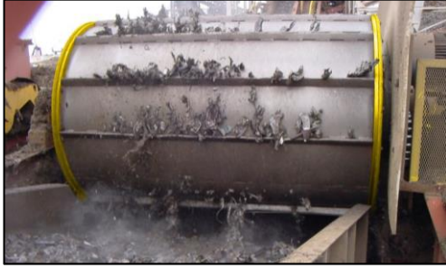
Figura 10. Separación Magnética de Metales de Equipos RAEE
