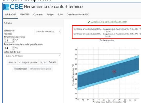
Nota. El grafico muestra los rangos operativos aceptables para una temperatura de  $25^{\circ}\text{C}$ . Adaptado de Herramientas de Confort Térmico, CBE THERMAL TOOL, 2019, <https://comfort.cbe.berkeley.edu/>. CC
