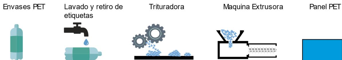
Nota. La figura muestra el proceso de reciclaje al cual se somete el material PET para la construcción de un panel
