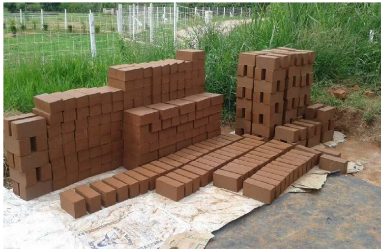
Imagen 33 Apilamiento de bloques. Fuente: Propia.
