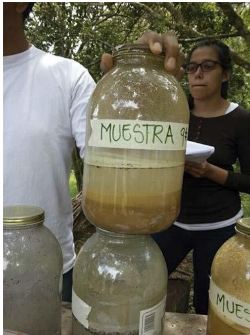
Imagen 29 Proporción entre arenas, limos y arcillas.
