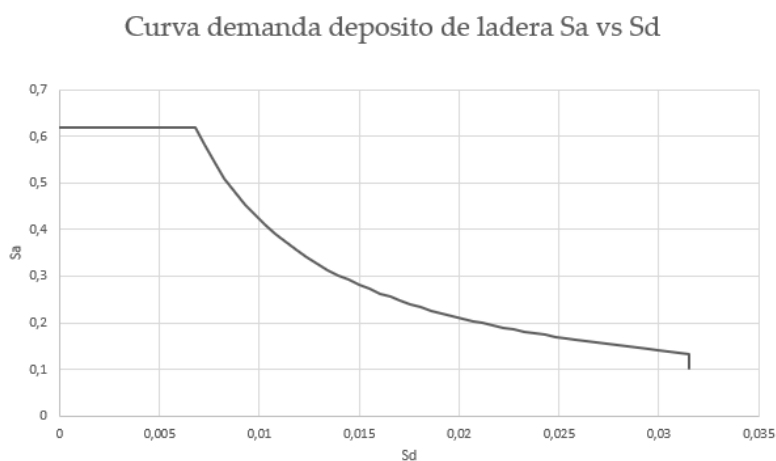
Figura 11.12: Curva de Demanda Depósitos de Ladera
