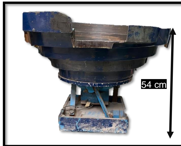
Figura 27. Vista frontal de la tolva.
