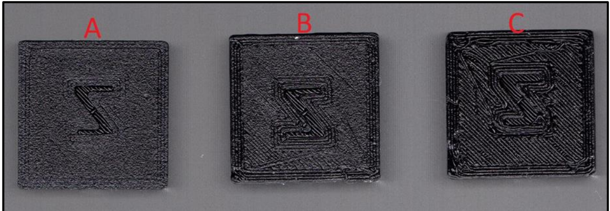
Ilustración 61. Caras del eje Z de los tres cubos nivelados con distintas formas de calibración
