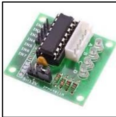
Ilustración 17. Circuito integrado ULN2003 montado en una PCB.
