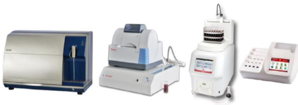
Figura 15. Equipos auto analizadores en enología, de izquierda a derecha: WineScan (Foss), Bacchus 3 MultiSpec (Tecnología Difusión Ibérica), SpectraAlyzer Wine & Spirits (Zeutec) y WineLab Touch (CDR FoodLab)
