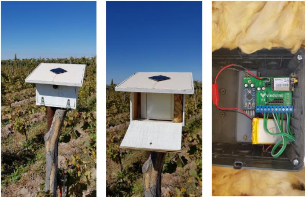
Figura 9. Plataforma de sensores en el viñedo (izquierda y centro) y hardware “ Vinduino ” (derecha) (Jiménez, 2018)
