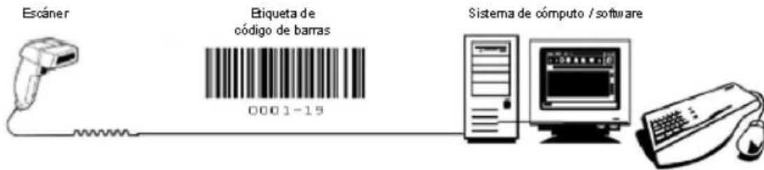
Figura 18. Componentes de un sistema de código de barras (Li, 2012)
