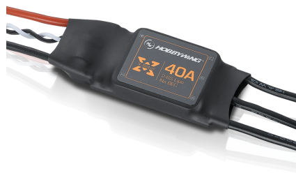
Figura 2.6 y Tabla 2.4: Los reguladores electrónicos de velocidad seleccionados presentan 7 terminales: por un lado, las 3 fases del motor; por el otro, los 2 bornes de la batería y las 2 señales de comunicación.
