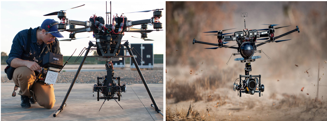
Figura 2.3: El cuadricóptero de hélices coaxiales Mapper X8, de la compañía xFold, es uno de los preferidos en los principales estudios cinematográficos.
