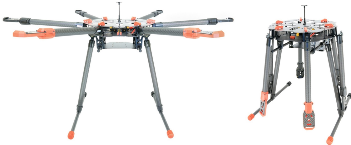
Figura 2.2: La plataforma Tarot X6, fabricada casi en su totalidad en fibra de carbono, cuenta con un tren de aterrizaje retráctil, brazos plegables, bandeja porta accesorios y PCB integrada.
