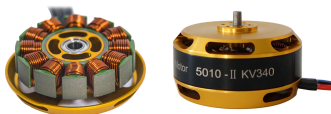
Figura 2.5: Los motores sin escobillas TYI 5010-II KV340 son resistentes al polvo y la humedad. Sus imanes, denominados “de tierras raras”, están hechos de una aleación de neodimio, hierro y boro ( Nd_2Fe_{14}B ). Los imanes de tierras raras producen campos magnéticos significativamente mayores que los de ferrita o alnico.
