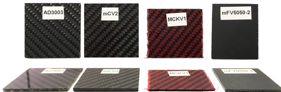
Figura 5.9: Muestras comerciales de planchas de fibra de carbono pura (AD3003), fibra de vidrio pura (mFV-5050-2), sandwich fibra de carbono-kevlar (MCKV1); y sandwich fibra de carbono-vidrio (mCV2).
