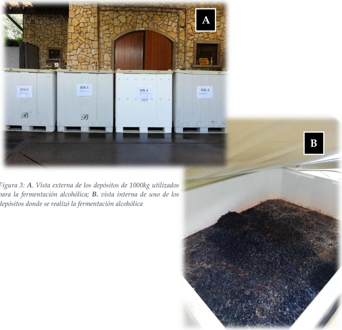
*Figura 3: A. Vista externa de los depósitos de 1000kg utilizados para la fermentación alcohólica; B. vista interna de uno de los depósitos donde se realizó la fermentación alcohólica*
