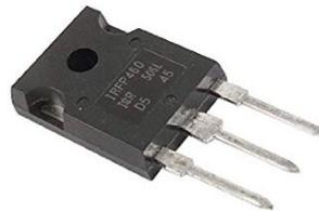
*Ilustración 78 - Transistor MOSFET IRFP460. Fuente: Aliexpress*
