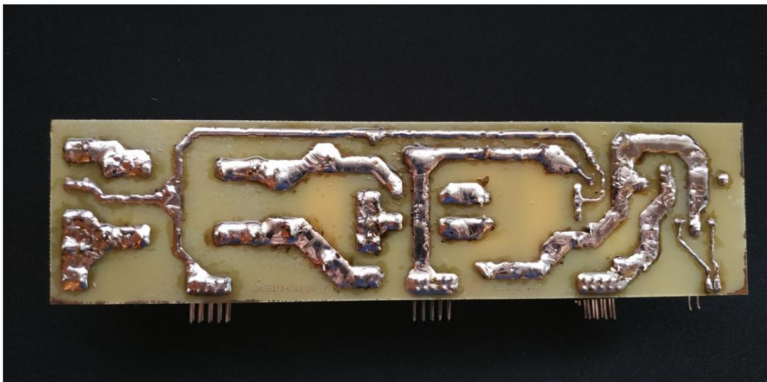
Ilustración 70 - PCB etapa de entrada. vista inferior. Se observan las pistas estañadas
