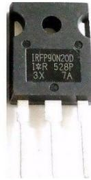
Ilustración 113 - Transistor MOSFET IRFP90N20D
