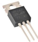
*Ilustración 133 - Transistor MOSFET IRFZ44. Fuente: Aliexpress*
