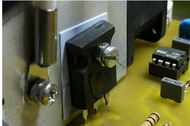
*Ilustración 226 - Daños en el MOSFET del convertidor PFC. Se observa grieta en el cuerpo del transistor*
