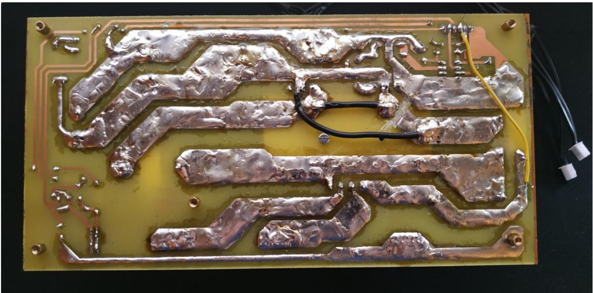
*Ilustración 84 - PCB completa convertidor Boost PFC. Vista inferior. Nótese que se han cubierto las pistas más importantes con estaño*
