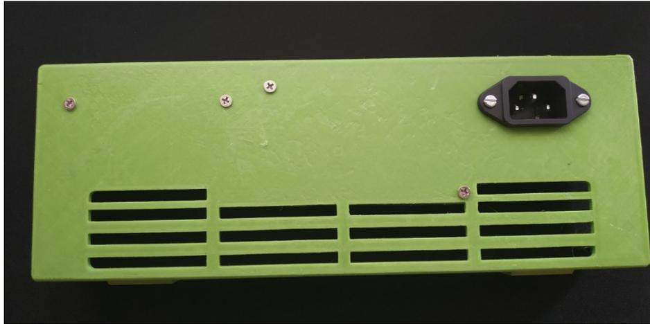
*Ilustración 52 - Montaje panel trasero con conector AC. Vista exterior*
