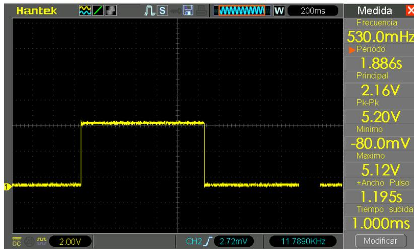
Ilustración 35 - Nivel de tensión generado por el contador CD4013 al cambiar de sentido de giro.
