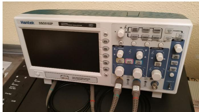
*Ilustración 220 - Osciloscopio Hantek 5102P 100 MHz*
