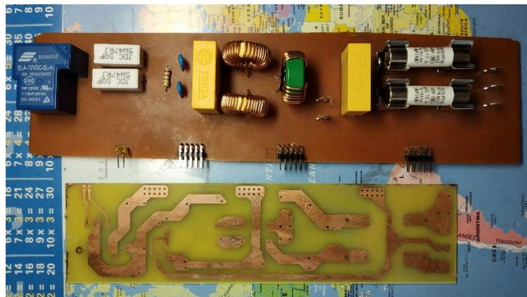
Ilustración 224 - Prototipo original del filtro EMI (Arriba), segunda versión (Abajo)
