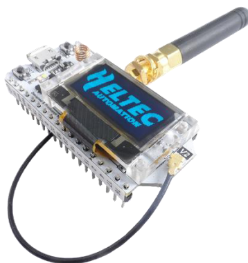
Ilustración 1. 19. WiFi LoRa 32 (V2) Heltec
