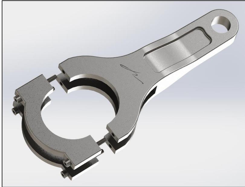
*Ilustración 6.13: Modelado de la biela externa - Resultado final.*
