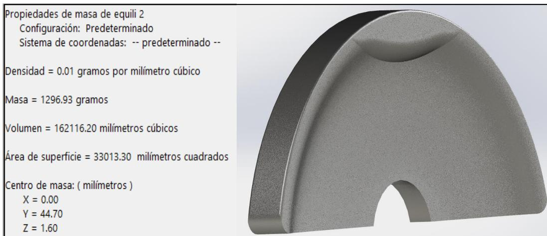
Ilustración 6.15: Modelado del cigüeñal - Contrapeso.
