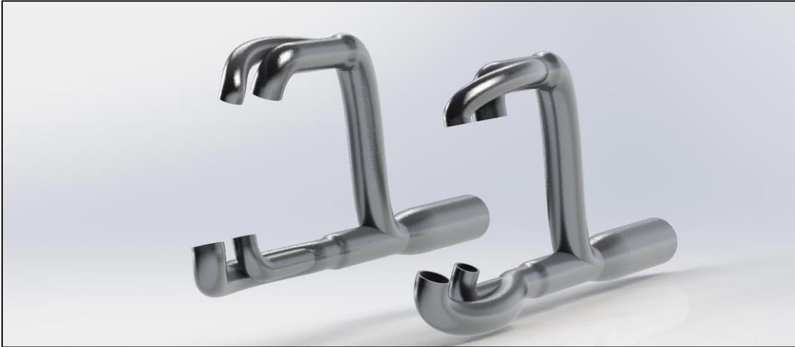
Ilustración 6.99: Modelado del escape - Resultado final.
