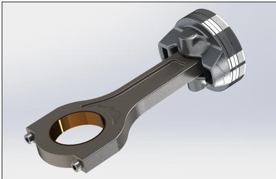
*Ilustración 7.4: Ensamble Pistón y Biela - Biela interna.*
