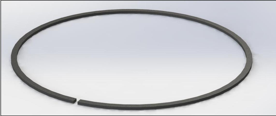
*Ilustración 6.107: Modelado de segmentos - Segmento de fuego - Resultado final.*
