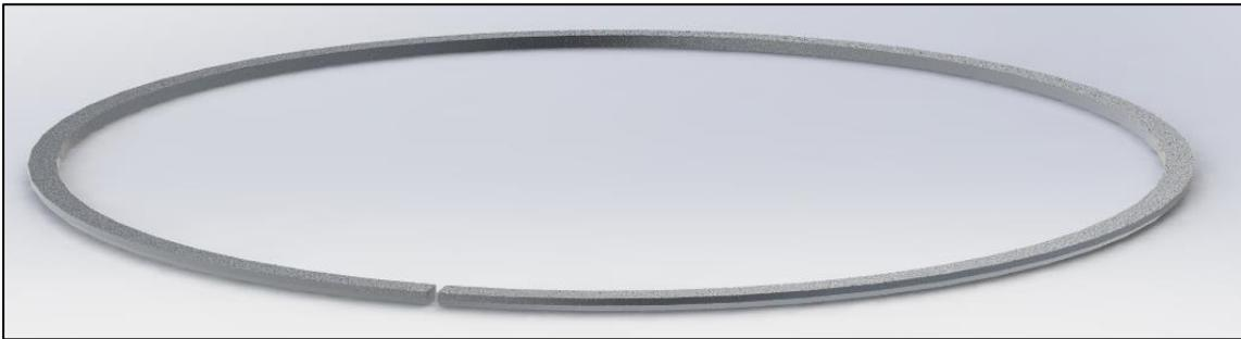
*Ilustración 6.108: Modelado de segmentos - Segmento de compresión - Resultado final.*
