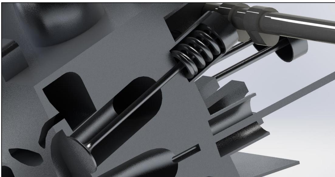
Ilustración 6.89: Modelado de válvula y resorte - Conjunto válvula, resorte, árbol de levas, culata.
