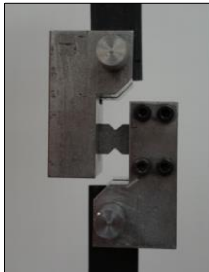
Ilustración 6.3.3 Mordazas ensayo de corte en máquina de tracción
