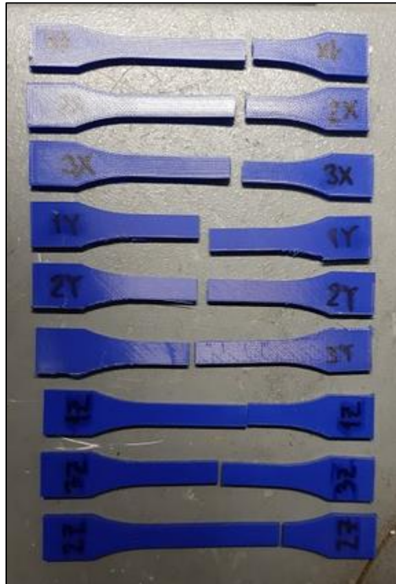
Ilustración 6.2.2 Tanda de 9 probetas ensayo tracción
