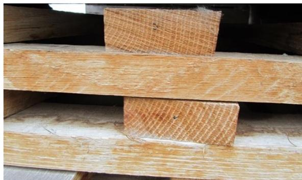
**Figura 3.** Diferencias en los anillos de crecimiento en función del tipo de corte de las duelas
