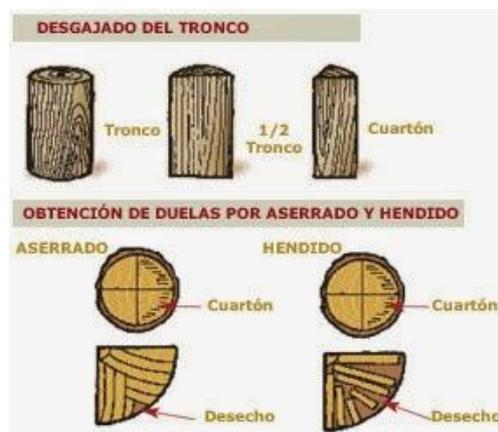
**Figura 5.** Diferencias entre la obtención de duelas por hendido y aserrado
