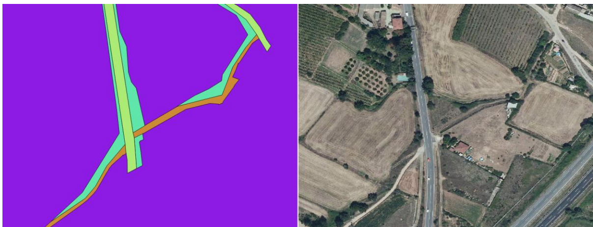
Figura 3.5. Capa vectorial (izquierda) y capa ráster (derecha) que representan la misma zona geográfica.
