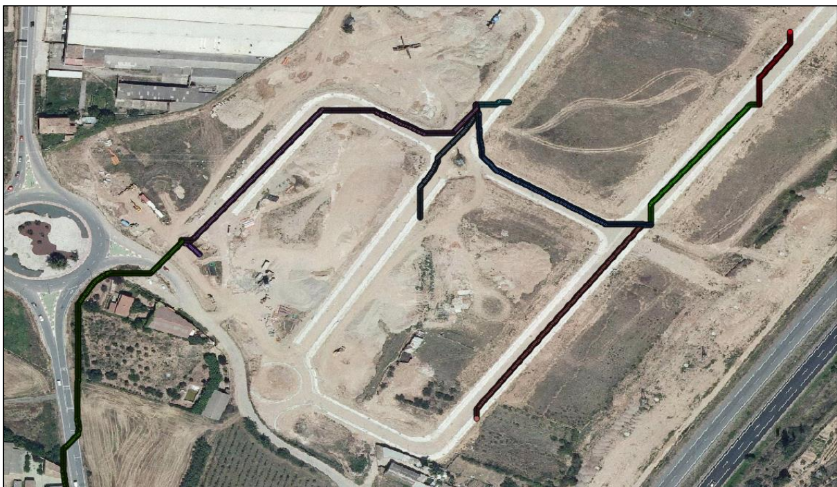
Figura 6.30. Detalle de los caminos de menor coste acumulado en la zona industrial utilizando el conductor de 240mm 2 (utilizando capas vectoriales tipo punto).
