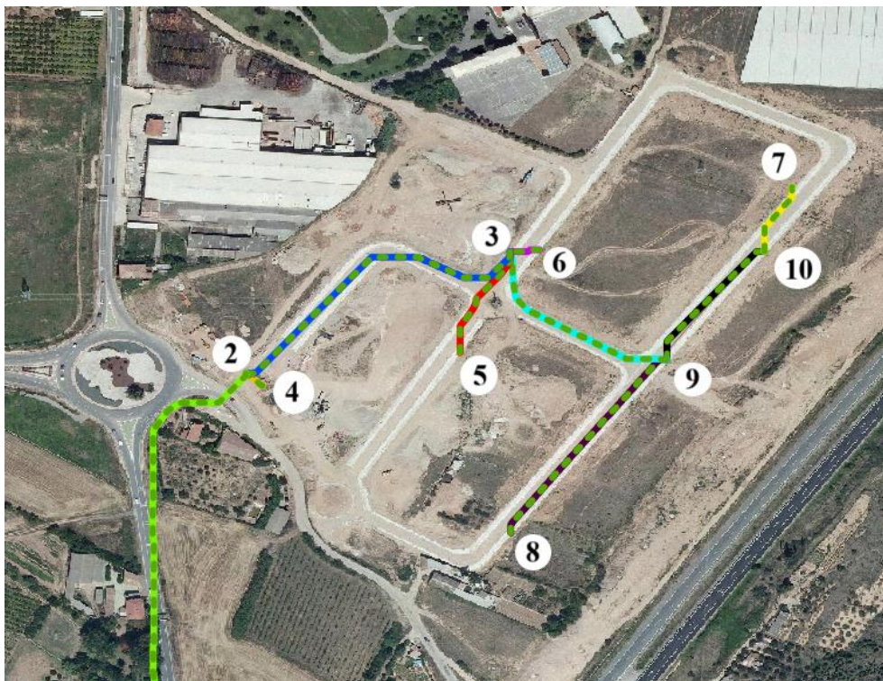
Figura 6.27. Detalle de los caminos de menor coste acumulado en la zona industrial utilizando el conductor de 400mm 2 (utilizando capas vectoriales tipo línea).
