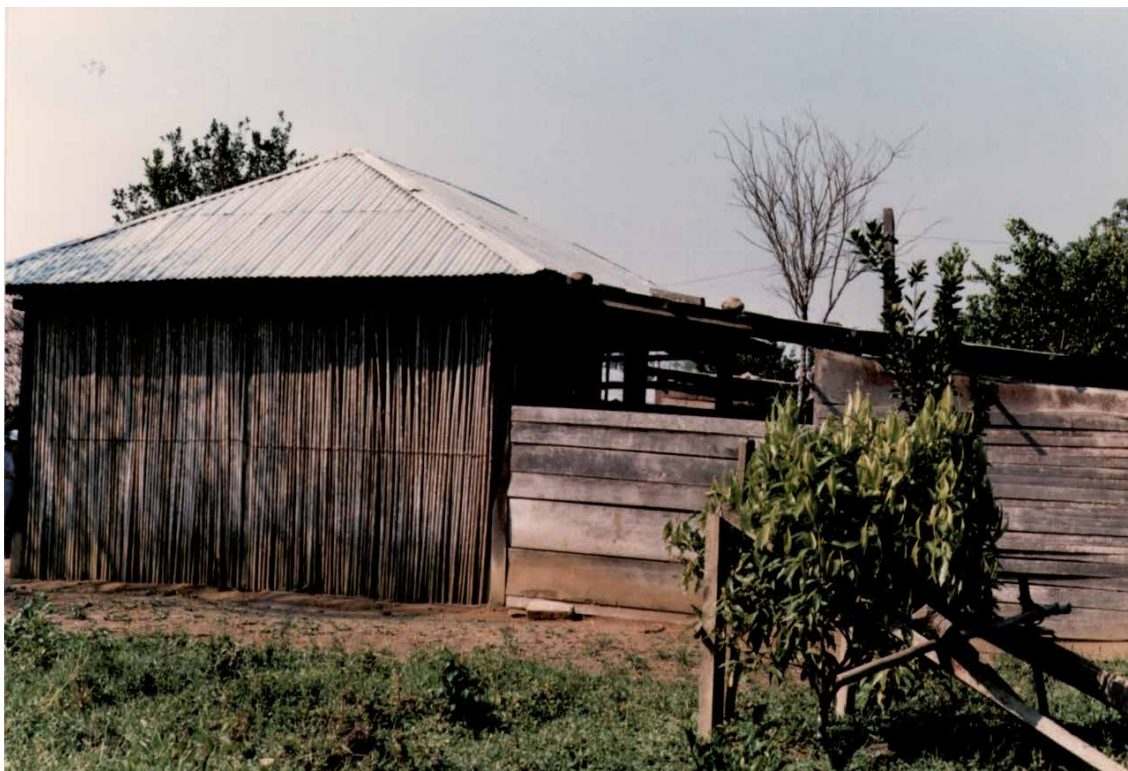
Foto 474: Fachada posterior de la vivienda. Se observa las paredes de caña-brava amarrada y el cerco de tablas. Fuente: Olórtogui & Rummenhöller (1989).
