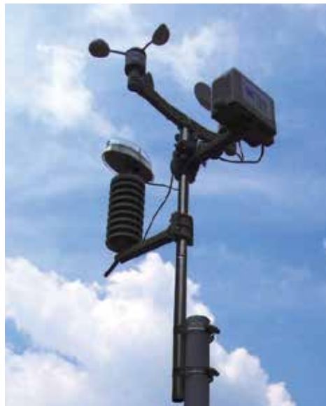
Figura 34. Estación meteorológica instalada en la lechería del ITCR-SSC (Santa Clara) para monitorear la potencia solar que incide sobre la superficie.
