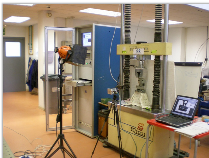
Figura A.31 Montaje del ensayo a flexión de probetas de mortero.
