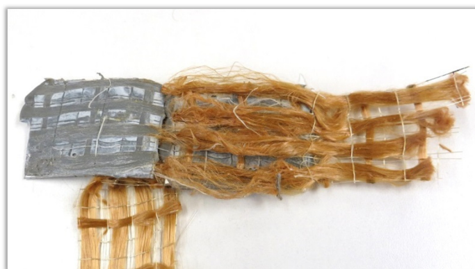
Figura A.65 Impregnación deficiente del adhesivo en tejido de PBO .
