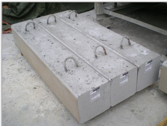
Figura B.3 Vigas V terminadas y en fase de curado.
