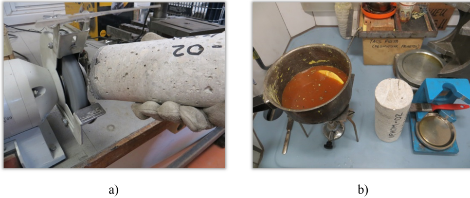
Figura A.3 Procesos previos al refrentado de las probetas de hormigón: a) pulido de las rebabas, b) licuación del azufre.
