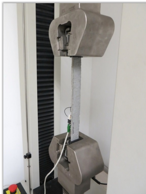
Figura A.81 Posición inicial del ensayo a tracción de probetas de TRM.
