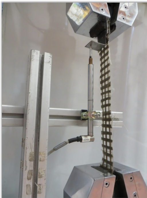
Figura A.60 Posición inicial del ensayo a tracción en tejidos de fibras.
