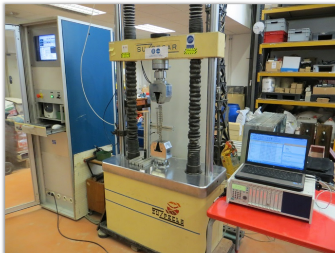
Figura A.59 Montaje del ensayo a tracción en tejidos de fibras.
