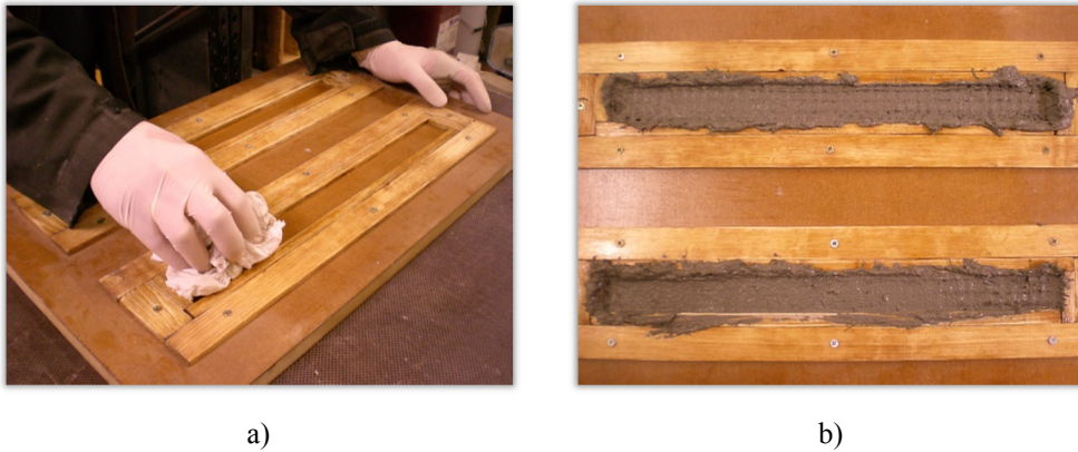
Figura A.76 Preparación de las probetas de TRM: a) impregnación del encofrado con líquido desencofrante, b) tejido embebido en la primera capa de mortero.
