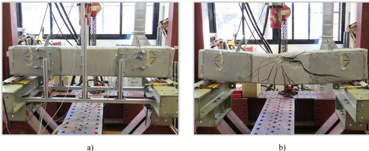
Figura B.26 Ensayo viga V-BR3-02: a) inicio del ensayo, b) final del ensayo.
