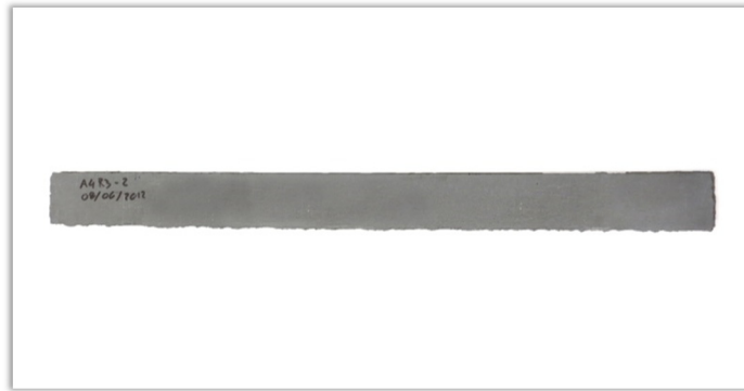
Figura A.78 Probeta de TRM en fase de curado.
