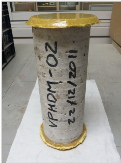
Figura A.5 Probeta de hormigón refrentada en fase de curado.
