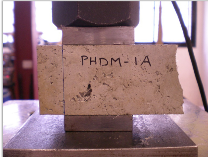
Figura A.36 Posición inicial del ensayo a compresión en probetas de mortero.
