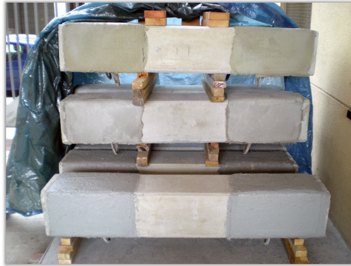
Figura B.7 Vigas V durante la fase de curado de los refuerzos.
