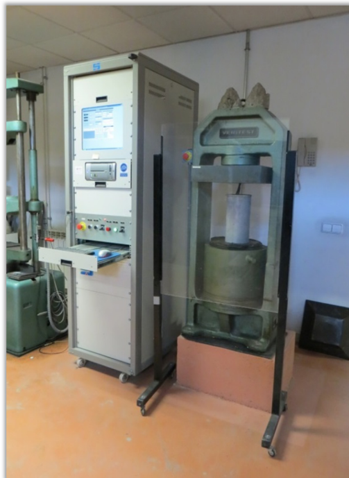
Figura A.10 Montaje ensayo a compresión en probetas de hormigón.
