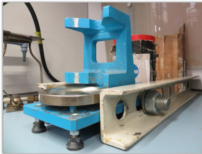
Figura A.2 Molde normalizado utilizado en el proceso de refrentado de las probetas de hormigón.
