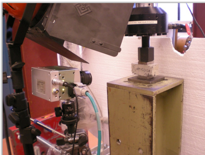
Figura A.35 Montaje del ensayo a compresión en probetas de mortero.
