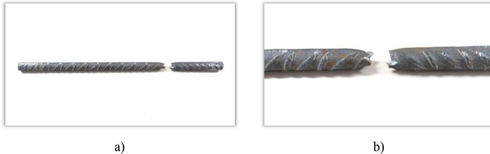
Figura A.20 Aspecto de una barra corrugada de acero después del ensayo a tracción: a) visión general, b) detalle zona rotura.
