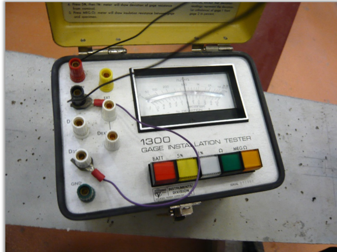
Figura B.15 Verificador utilizado para la comprobación de las galgas extensométricas instaladas.
