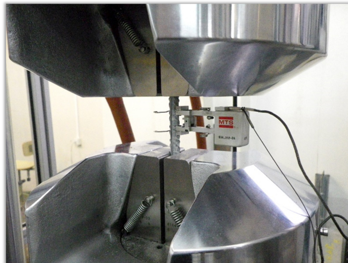
Figura 3.2 Ensayo realizado en barras corrugadas de acero.
