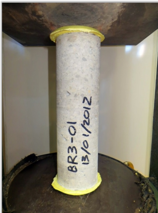
Figura A.11 Posición inicial del ensayo a compresión en probetas de hormigón.
