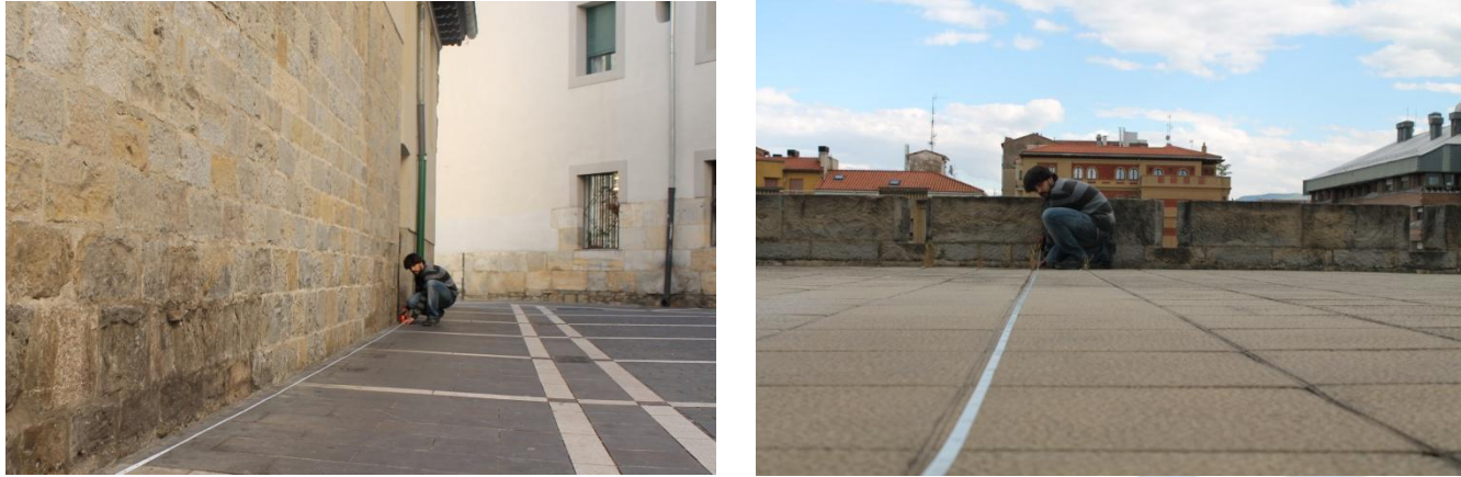
Img.115-116. Medición del exterior y cubierta de la torre con la cinta métrica de 30 m
