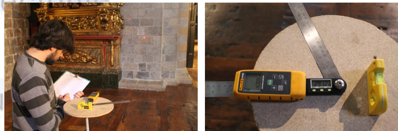
Img.113-114. Medición por radiación, a la drcha.. vemos el metro laser, la escuadra digital y el nivel
