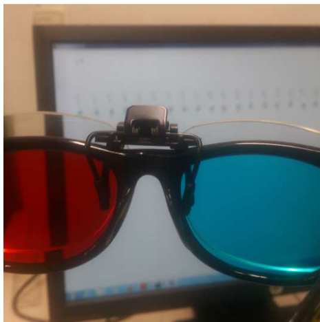
Imatge 6 Visualització del test a través de les ulleres anaglífiques, a les que s'avantposen les lents o prismes per modificar la condició d'acomodació o convergència.
