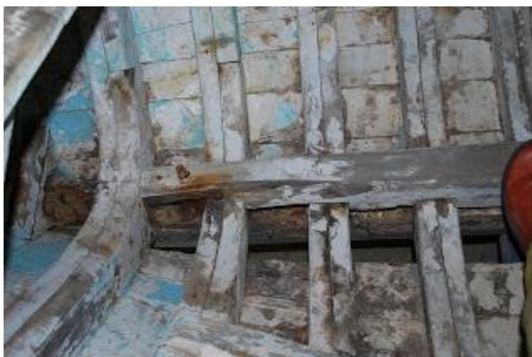
Figura 4. Primera tabla del forro y parte de la sobrequilla afectada por la podredumbre en una embarcación de madera - [restaurarbarco.blogspot.com.es/](http://restaurarbarco.blogspot.com.es/)
