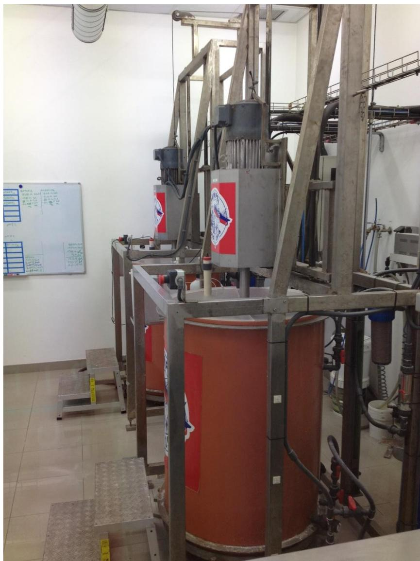
Figura 21. “Lab rotors” para el ensayo acelerado de pinturas antiincrustantes en agua salada artificial
