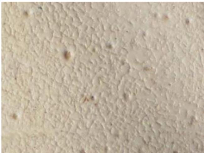
Figura 46. Superficie de fibra de vidrio aumentada 32 veces. Presenta “cabezas de alfiler” en la superficie pigmentada. Manual de aplicación Gelshield Plus. International Coatings Limited
