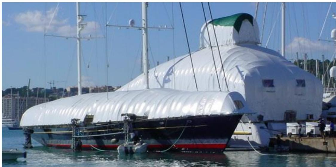
Figura 40. Embarcaciones con la carpa protectora instalada - [www.fondear.org](http://www.fondear.org)
