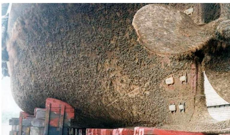
Figura 7. Casco afectado por las incrustaciones - <http://magazineoceano.com>
