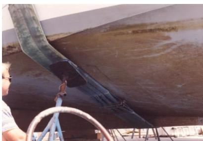
Figura 9. Limo adherido a un casco - La Ciencia de los Antifouling, International Yacht Paint
