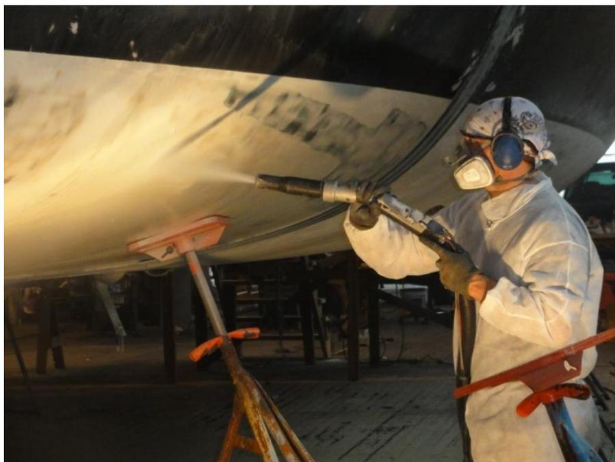
Figura 42. Chorreado de arena a embarcación de acero - <https://www.cjspray.com/products/ecoquip/ecoquip-eq600s-vapor-blast-equipment.html>
