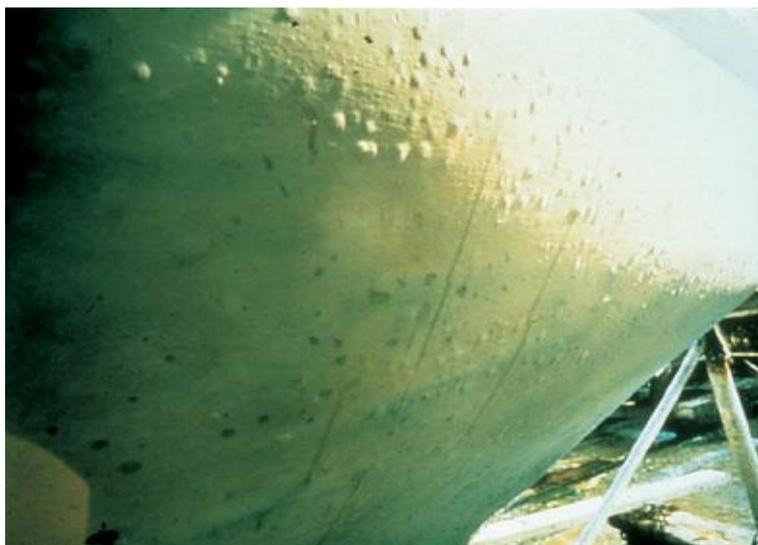
**Figura 48. Ampollas presentes en un casco de fibra de vidrio.** Manual de aplicación Gelshield Plus. International Coatings Limited
