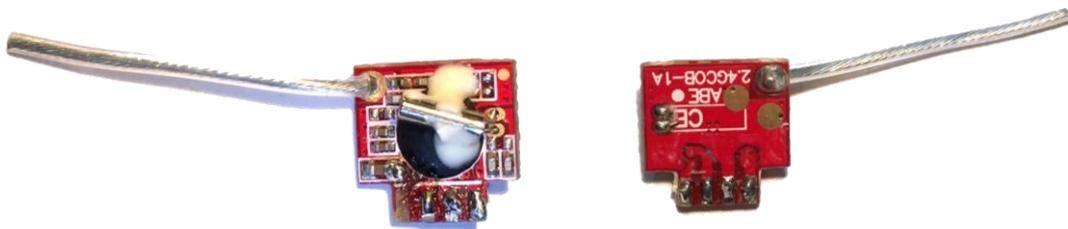
Figura 2: Módulo RF BK2421 incluido en la emisora de SkyWalker Drone
