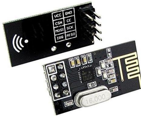
*Figura 3: Módulo NRF24L01*
