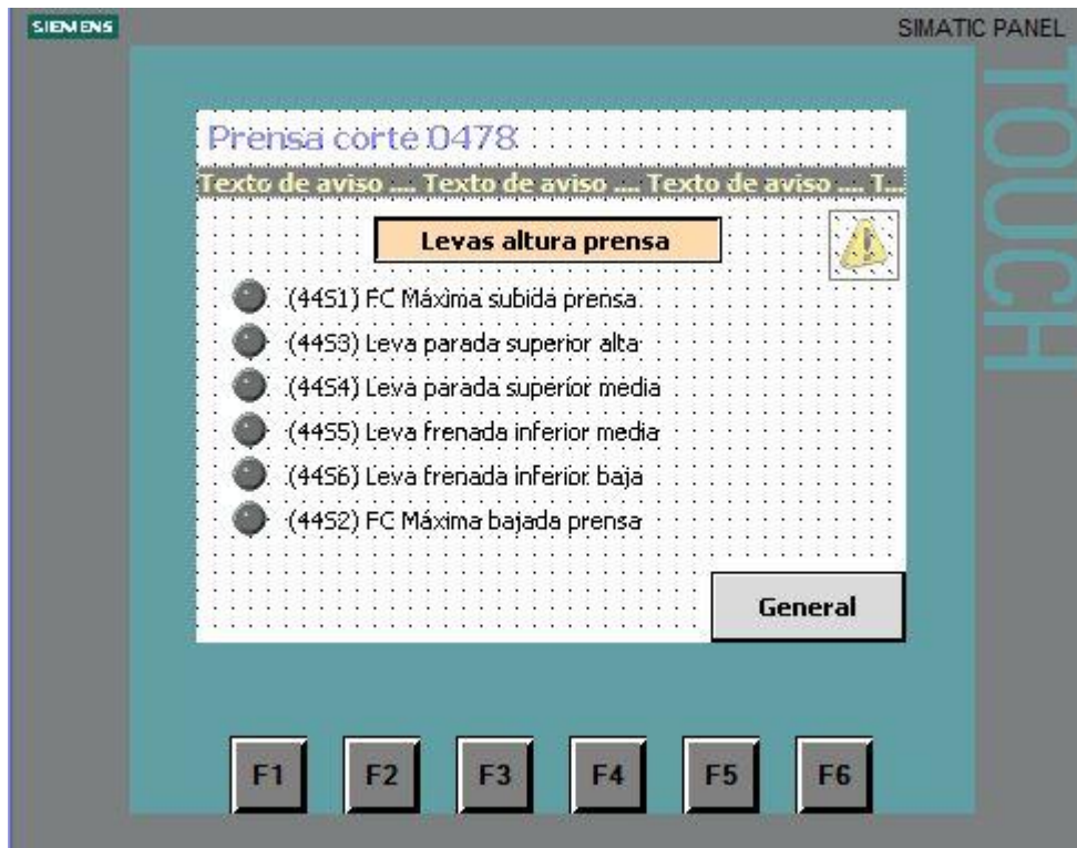
Ilustración 45. Levas altura bloque prensa troqueladora.
