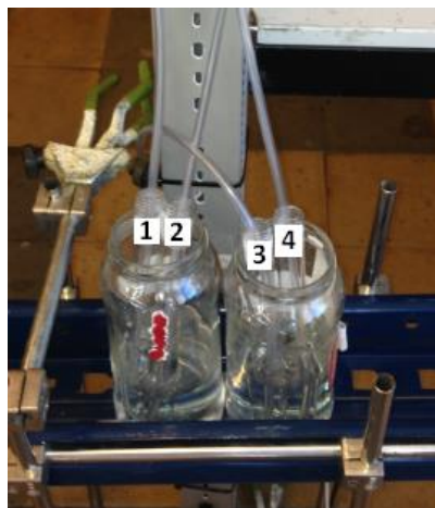
Figura 7.1.5. Sistema utilitzat per fer bombolejar les mostres d'aire des de 4 alçades diferents a l'interior dels tubs d'assaig respectius.
