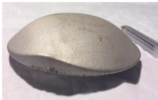
Figura 4.5.4.1.3.1. Imatge d'un ànode utilitzat en diversos assajos.
