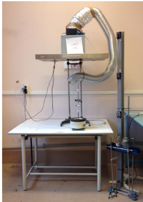
Figura 7.3.1. Dispositiu emprat per a l'obtenció de mostres a diferents alçades.
