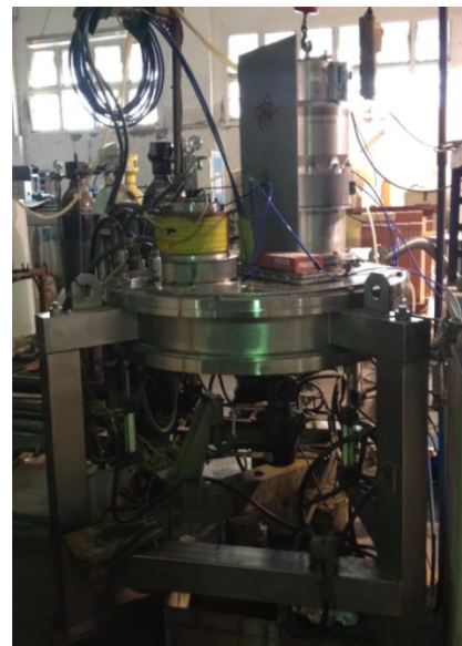
Figura 4.5.4.1.3.3. Reactor horitzontal on es va realitzar la deposició física de titani + diòxid de titani al filtre d'alumini.
