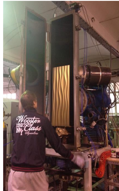
Figura 4.5.4.1.3.5. Placa de ceràmica després de la deposició física de Ti + TiO_2 .
