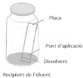
Figura 1.1.1.1.2. Esquema del mètode per depositar la mescla a la tira.
