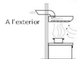
Figura 2.2.1. Campana de descàrrega a l'exterior.
