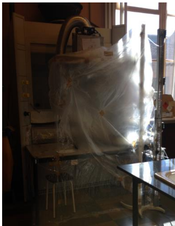
Figura 7.3.1.1. Segona campana extractora utilitzada, on les bombes peristàltiques restaren fora de la protecció plàstica.
