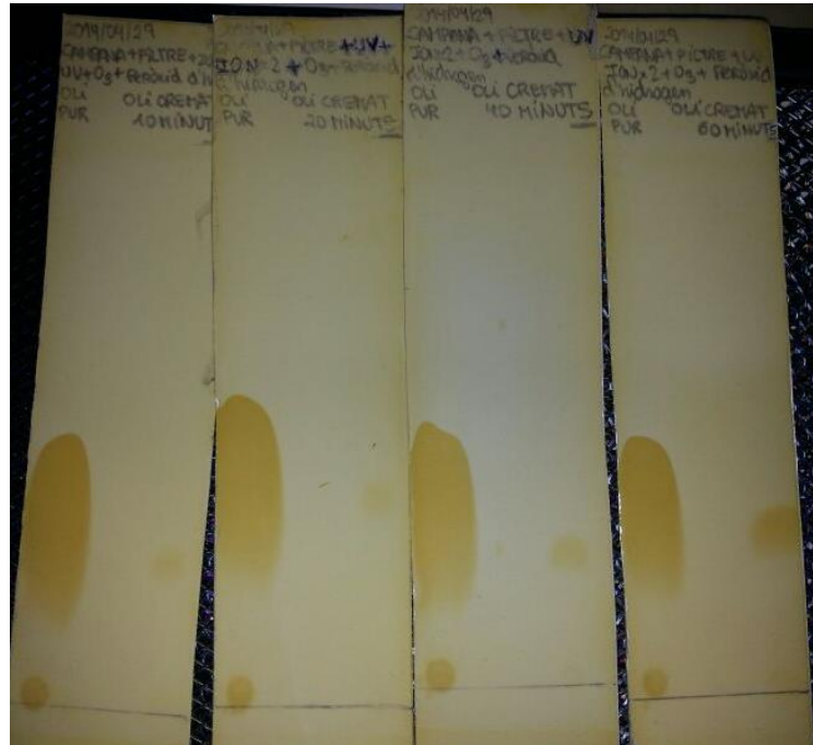
Figura 8.2.3.8.1. Influència conjunta del filtre, de l'ionitzador + l'ozonitzador + radiació UV + H_2O_2 sobre la reducció de la concentració d'oli d'oliva.
