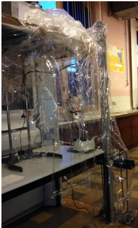
Figura 7.2.1.6. Campana extractora coberta amb un plàstic, on les bombes peristàltiques estan cobertes.
