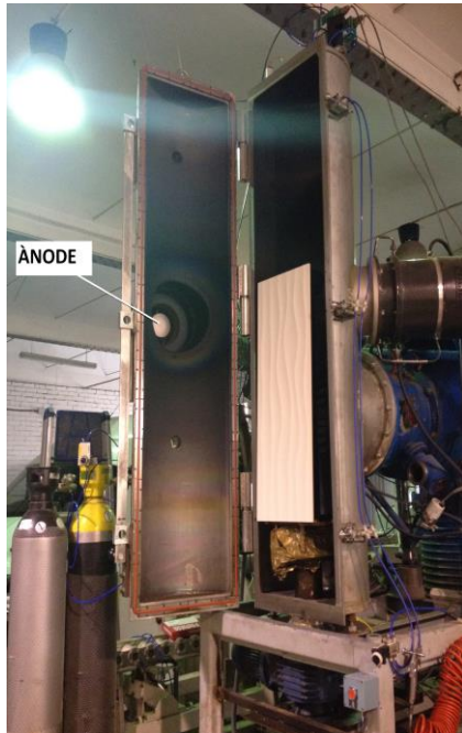
Figura 4.5.4.1.3.4. Placa de ceràmica abans de la deposició física de Ti + TiO_2 .
